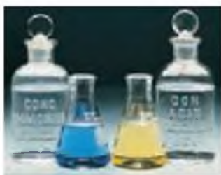
▲ Figura 4.7 Indicador ácido-base azul de bromotimol. El indicador es azul en una disolución básica, y amarillo en una ácida. El matraz de la izquierda muestra al indicador en presencia de una base, amoníaco acuoso (rotulado como hidróxido de amonio). El matraz de la derecha muestra al indicador en presencia de ácido clorhídrico, \text{HCl} .
